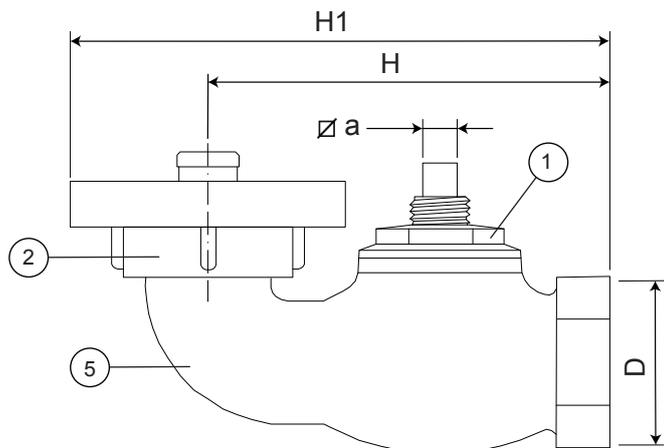
Para parede sem ramal saída storz
