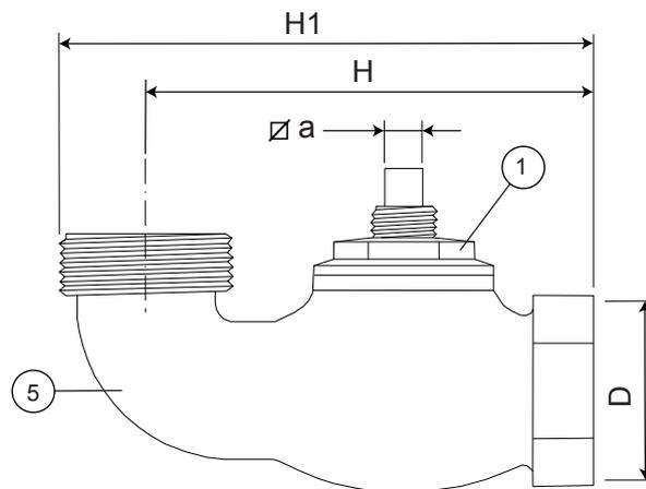
Para parede sem ramal saída roscada
